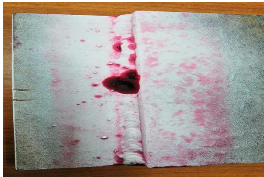
شكل (4) يوضح استخدام الصبغة النفاذة للكشف عن العيوب
